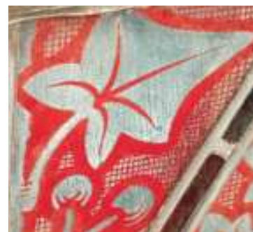
Dit wit uitgeslagen glas is het gevolg van een reiniging met een te agressief middel, dat ook nog eens onvoldoende is verwijderd, waardoor de aantasting van het glas zich na de reiniging voortzette. De krassen in de witte laag zijn het gevolg van reiniging met een te harde borstel
