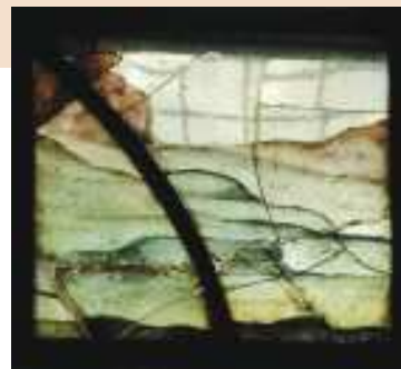
Verlijmd stukje gebrandschilderd glas, met aanvullingen in kunsthars. Ter plaatse van het gehandhaafde breukloodje achtte de restaurator de hoeveelheid afgegruisd glas blijkbaar te veel om ook hier de ontbrekende delen met hars aan te vullen
